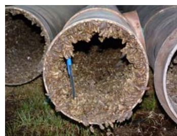
Fig. 1. Limnoperna fortunei , en cañerías de PVC de empresa de recursos hidráulicos (Fotos brindadas por Ernesto Brugnoli y Pablo Muñoz).
