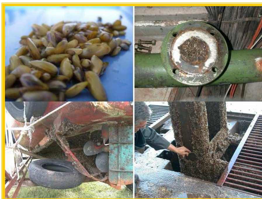
Figura 1. Limnoperna fortunei e infraestructuras afectadas (sistemas de refrigeración, embarcaciones, estructuras de contención).
